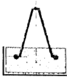
شکل ۳ - تیرچه بدون قالب ماندگار
