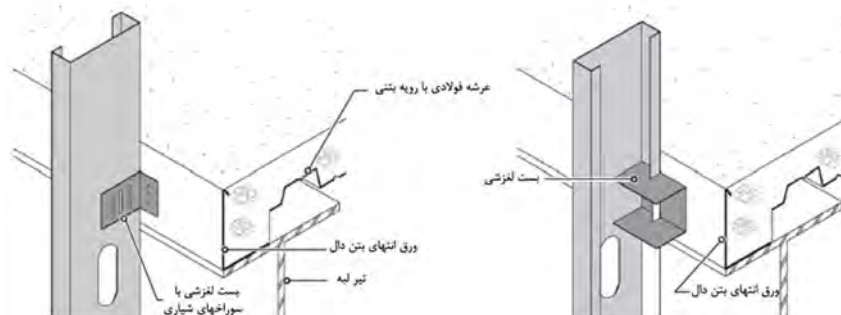
شکل ۳۷-۵- دو روش مختلف جهت ایجاد اتصال لغزشی بین پشت‌بند قائم و کف طبقات
