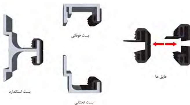
شکل ۷-۱۱- نصب درزپوش بر روی بستها
