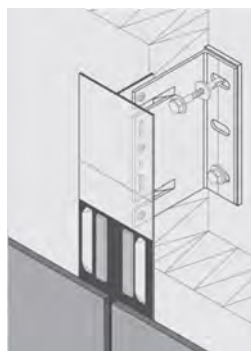
شکل ۷-۳۹- سیستم نصب پنهان با چسب صنعتی
