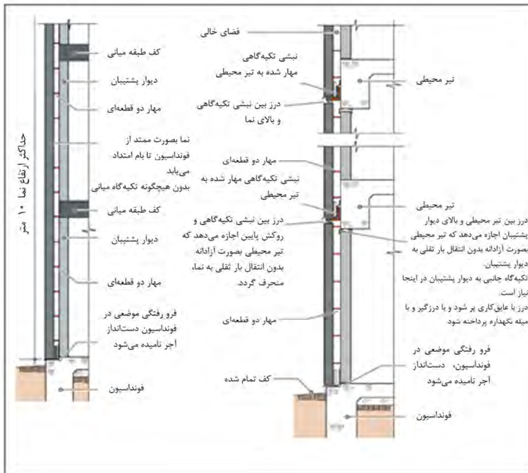
شکل ۵-۹- تکیه‌گاه‌ها جهت تحمل بار ثقیل نما
