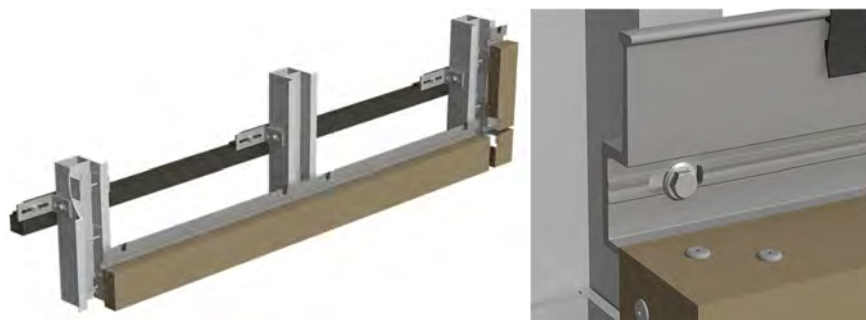
شکل ۸-۵- نمونه‌ای از روش اجرای ثابت-ریلی
