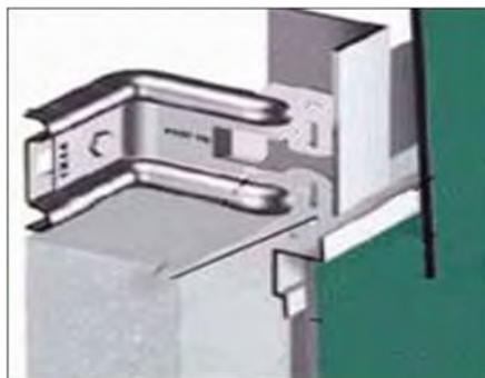
شکل ۶-۴۹- اجرای زیرسازی با استفاده از قطعات فولادی گالوانیزه شکل داده شده قابل تنظیم بر روی دیوارهای خارجی
