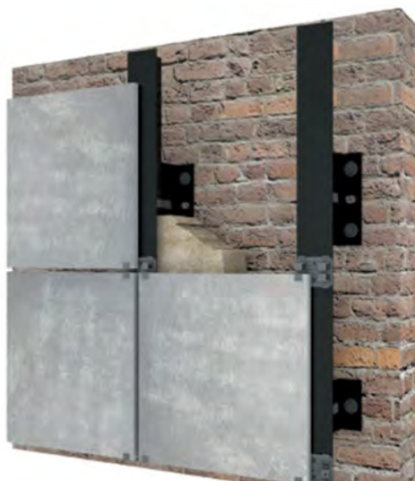
شکل ۷-۲۲- اجزای سیستم نصب نمایان
