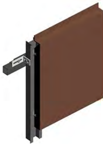
شکل ۸-۴- نمونه ای از روش اجرای هوک
